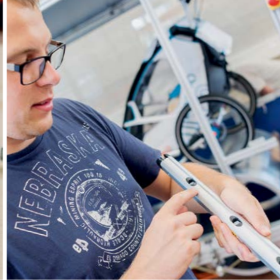
Immer mehr unterschiedliche Velotypen erfordern immer mehr verschiedene Kupplungen (Bild links). Die E-Bikes haben auch zu stärkeren Deichseln (Bild rechts) geführt.
